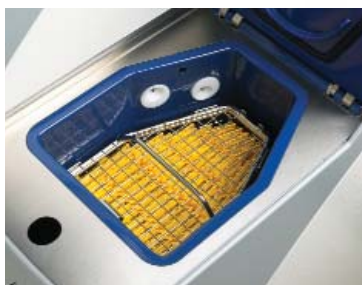
Kapazität der zweiten Kammer: bis zu 60 Kassetten
