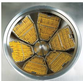
Kapazität der Reaktionskammer: bis zu 360 Kassetten
